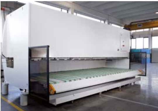
Convogliatore evacuatore con selettori sfridi. Belt conveyer with trim cut selector.
